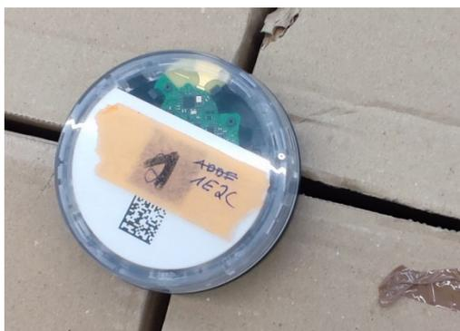
Abbildung 8. Eines der für die Messungen verwendeten UWB-Tags von Trumpf
